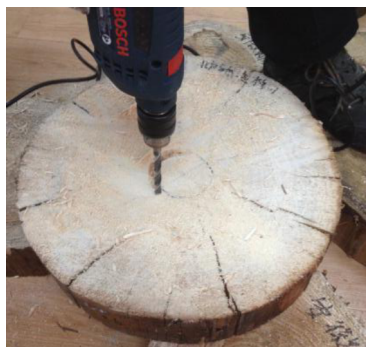
图2 冷杉试件内部空洞制备
